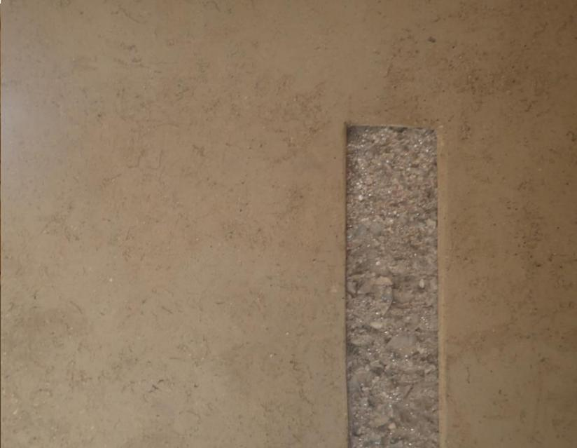
Revestimiento con morteros de arcilla, cal y cemento, con 50% de árido de mejillón.
